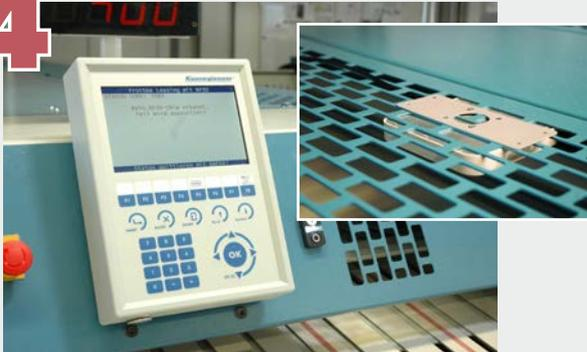
An der Frottierlegemaschine wurde das Ustek-System in Zusammenarbeit mit Maschinenhersteller Kannegiesser bereits weiterentwickelt. Ware mit fehlerhaftem oder fehlendem Chip wird jetzt automatisch aussortiert. Dazu wurde eine Zusatzantenne mit Funkverbindung zum Lesegerät am Packtisch installiert.
