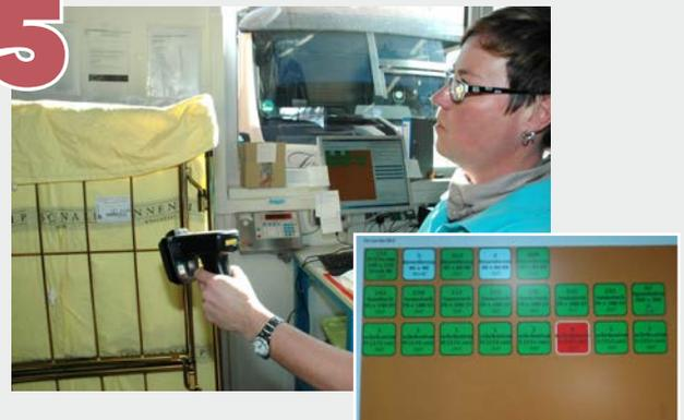
Warenausgang: Der Handscanner liest die einzelnen Transponder des Inhalts und des Containers. Das Barcode-Etikett bietet eine zusätzliche Kontrollmöglichkeit. Passen die Daten mit den in der EDV gespeicherten überein, springt das zugehörige Feld im Touchscreen-Display von rot auf grün. Sind alle Felder grün wird der Auftrag mit einem Lieferschein abgeschlossen und zur Expedition freigegeben.
