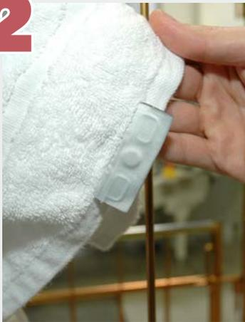
Leistungsstarke Transponder mit UHF-Technik (Ultrahochfrequenz) machen die Pulklesung von vielen Teilen erst möglich. Im Gegensatz zum knopfförmigen HF-Chip (Hochfrequenz) haben sie eine Antenne und damit eine wesentliche höhere Lesereichweite. Der patentgeschützte „Performer 55“ von Ustek wird ins Etikett gepatcht.
