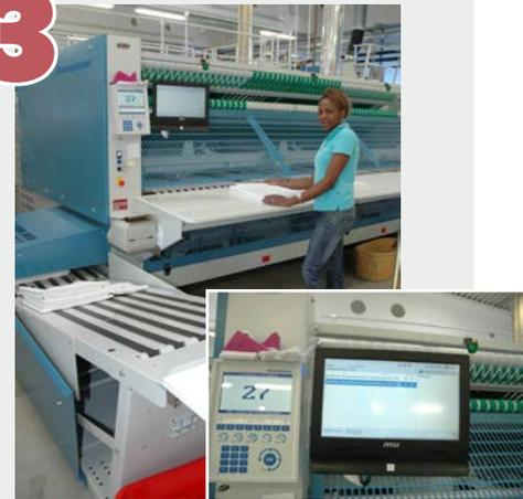
Weitere Lesegeräte sind auch an den Arbeitsstationen Mangel und Frottierlegestation unter dem Packtisch installiert. Die fertigen Teile werden damit sofort in der EDV erfasst. Als zusätzliche Sicherheit wird mit Fertigstellung des Containers ein Etikett mit Barcode angeheftet. Fürs Auge lesbar sind Artikel, Stückzahl, Kunde sowie Bearbeitungsinformationen ausgedruckt.
