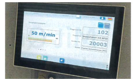
An der Mangel wurden verschiedene Temperatur- und Geschwindigkeitskombinationen untersucht und die jeweilige Restfeuchte der Textilien gemessen.
